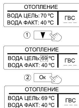
Рисунок 7. Настройка температуры теплоносителя
